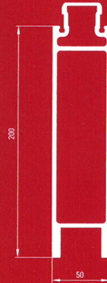
Hochwasserschutzprofil 50 mm H = 200 mm, ca. 6,25 kg/lfm
