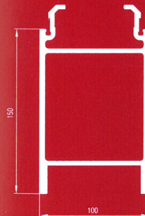
Hochwasserschutzprofil 100 mm H = 150 mm, ca. 6,25 kg/lfm
