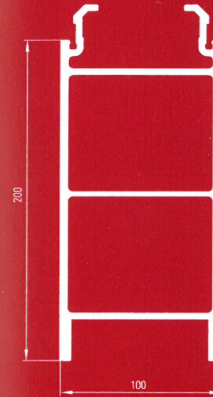
Hochwasserschutzprofil 100 mm H = 200 mm, ca. 9,80 kg/lfm
